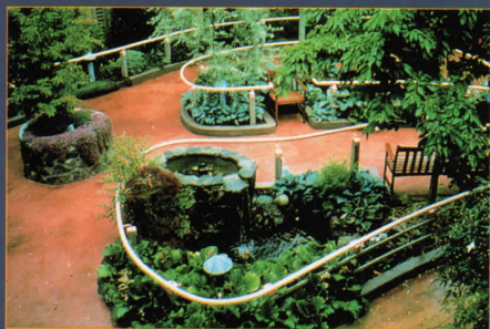
アルツハイマー患者のためのガーデン。楽に散策できるシンプルな動線と手すり。クレアを避けた色彩のコンクリート舗装。背もたれと肘かけのあるベンチなど様々な工夫がなされている
